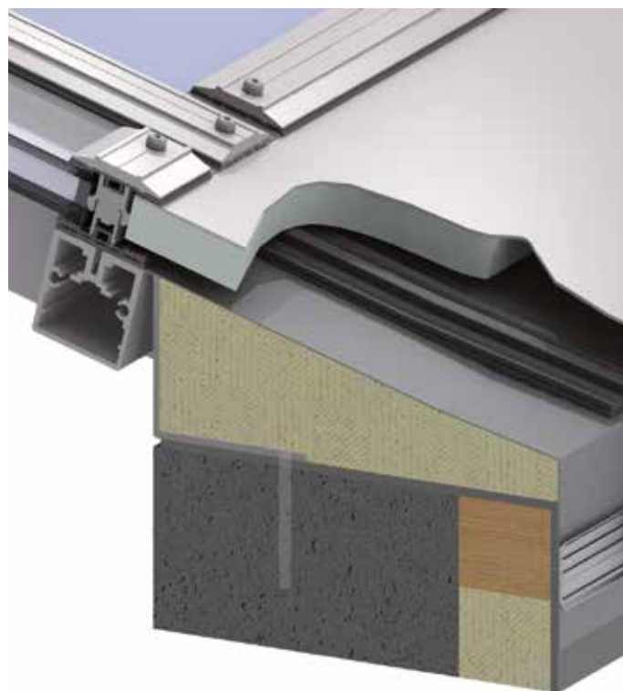
Монтаж на бетонном основании
