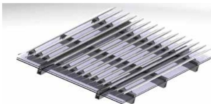
Жалюзи с наружной стороны
