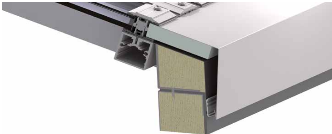
Монтаж на стальном основании
