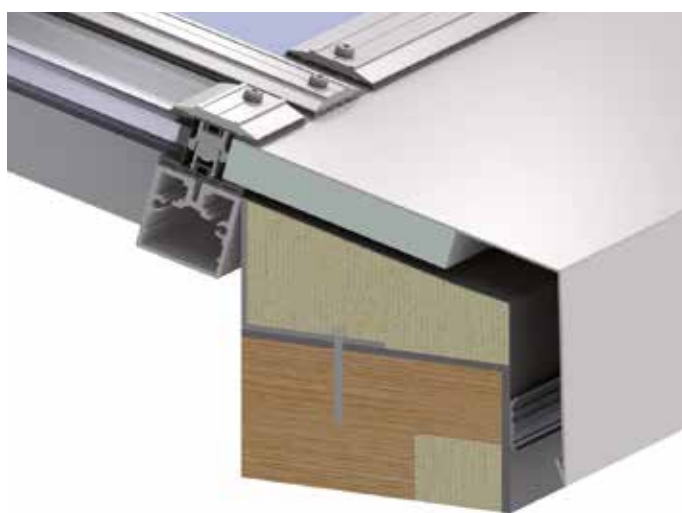
Монтаж на деревянной ферме
