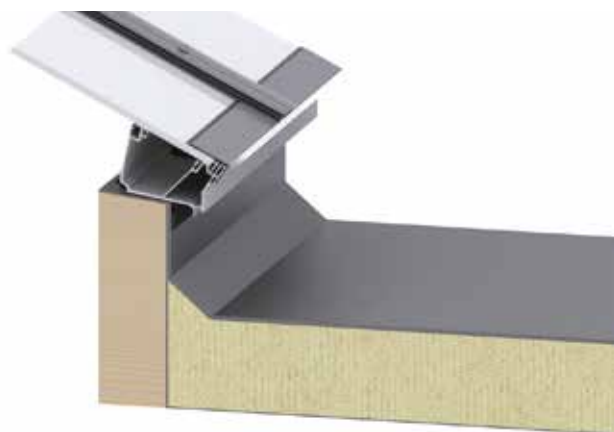
Монтаж на стропильной ферме
